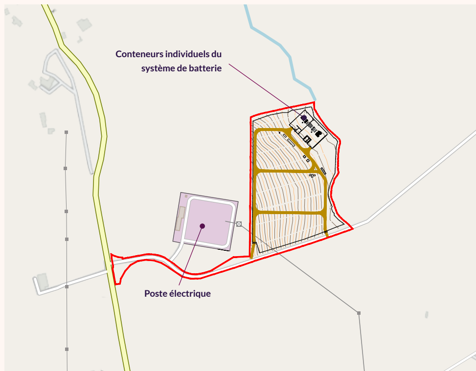
Schéma d'une installation de stockage par batterie
